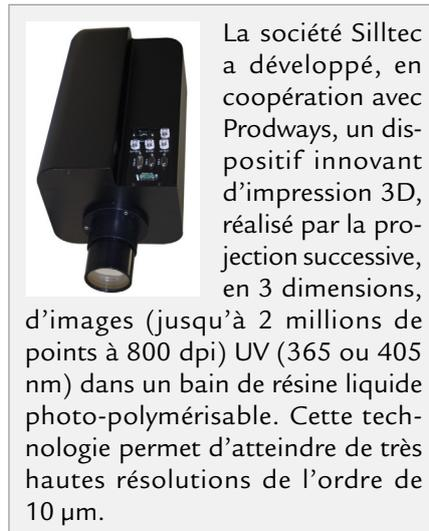
La société Silltec a développé, en coopération avec Prodways, un dispositif innovant d'impression 3D, réalisé par la projection successive, en 3 dimensions, d'images (jusqu'à 2 millions de points à 800 dpi) UV (365 ou 405 nm) dans un bain de résine liquide photo-polymérisable. Cette technologie permet d'atteindre de très hautes résolutions de l'ordre de 10 µm.
