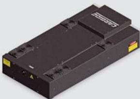
Light Conversion lance le laser femtoseconde CARBIDE, refroidi par air et compact (650 x 210 x 200 mm). Toute l'électronique de contrôle et les diodes de pompe sont incluses dans la tête laser, qui se branche directement à une prise secteur. La puissance est > 5 W @1028 nm avec des énergies par impulsion > 85 µJ. Le taux de répétition est variable de 50 à 1000 kHz, et des durées d'impulsions vont de 300 fs à 10 ps, le tout contrôlé par ordinateur.
