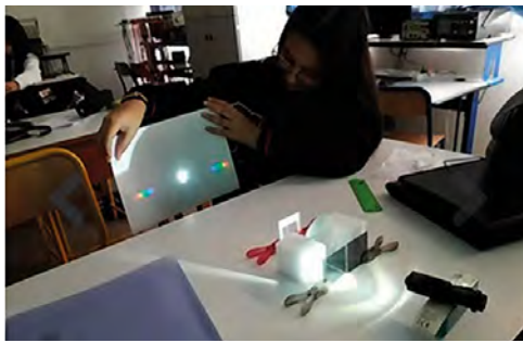
Visualisation de la diffraction grâce au Kit Light Box conçu par la Commission enseignement en collaboration avec l'association Atout Sciences.
