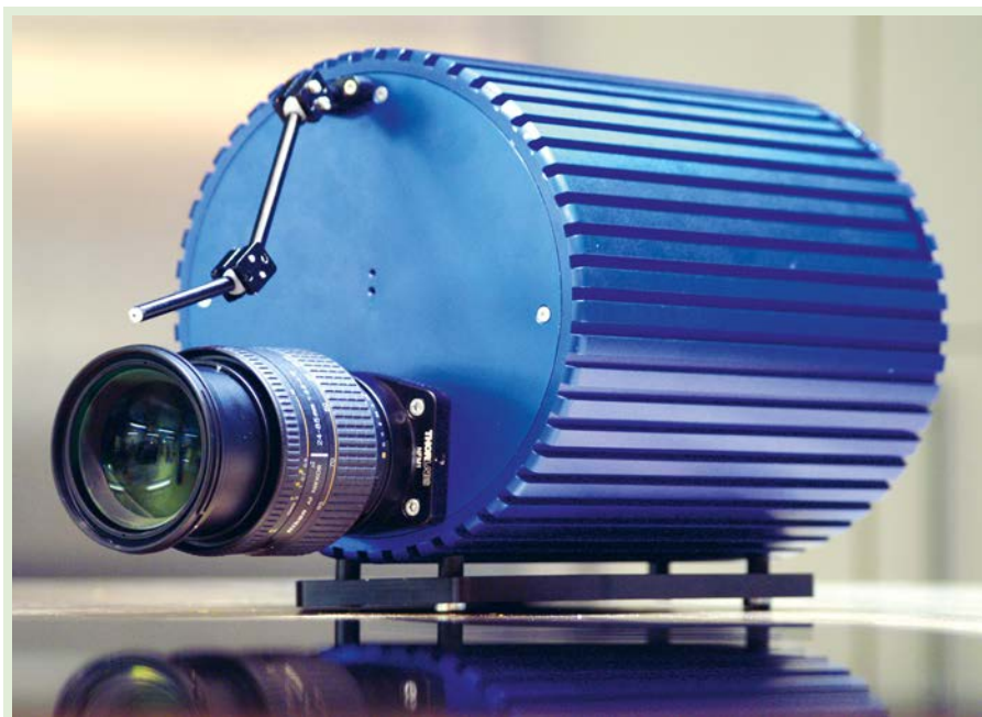
Un exemple de l'instrumentation photonique en Grand Est développée à ICube (projet FUI « SPIRIT ») : une caméra intensifiée à obturation ultrarapide offrant des performances à l'état de l'art mondial avec un brevet et transfert technologique vers la société Optronis GmbH. (Crédit : ICube, équipe SMH)
