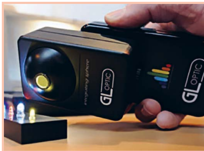
Figure 2. Parmi les applications, les mini-spectromètres à réseaux permettent la mesure et le contrôle des LED.
