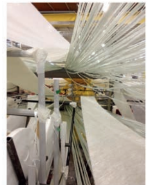
Bobine de fibres équipées de réseaux de Bragg avant insertion en composite
