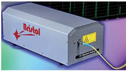
Les lambdamètres capables de mesurer plusieurs longueurs d'onde sont aussi appelés analyseurs de spectre. Source : Acal BFi/Bristol
