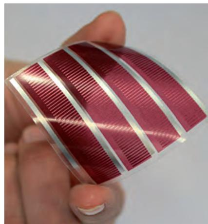
Figure 1. Les modules photovoltaïques, dits de 3<sup>e</sup> génération, fabriqués à partir de technologies de l'électronique imprimée, sont souples, fins et de couleurs et de formes variées.
