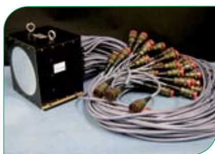
Le miroir déformable de l'instrument SPHERE pour la détection d'exoplanètes.
