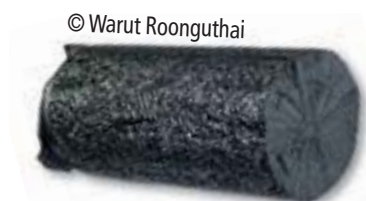
Figure 2. Barreau de silicium multicristallin.
