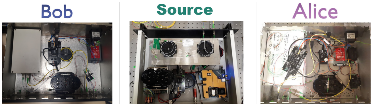
Figure 3. Travail d'intégration sur la source et les analyseurs de corrélation énergie-temps. La boîte "source" contient un laser à 780 nm, un guide d'onde non linéaire et des composants de routage/filtrage. Les boîtes "Alice" et "Bob" contiennent des interféromètres à base de fibre optique nichés dans des boîtiers thermiquement stabilisés. La partie électronique, pilotable à distance, qui gère la stabilisation en température, la puissance du laser et la phase des interféromètres est commune aux trois boîtes. Crédit image Y. Pelet (INPHYNI/CNRS).
