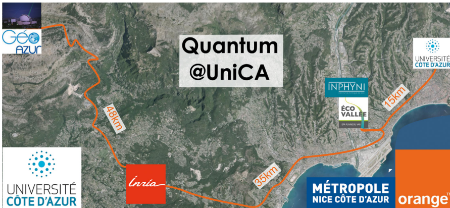
Figure 2. Plan du réseau Quantum@UniCA. Il s'étend sur une centaine de kilomètres avec 4 nœuds offrant tout l'équipement nécessaire pour produire et détecter des photons intriqués mais aussi analyser les corrélations temporelles inter-nœuds.
