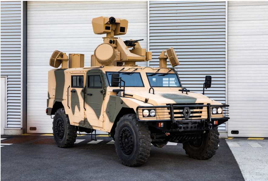
Figure 2. Système d'arme à énergie dirigée antidrone HELMA-P, High Energy Laser for Multiple Applications -P, développé par la société Cilas.
