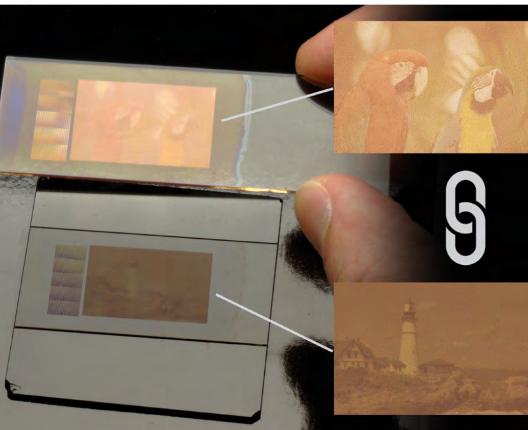
Figure 3. Image imprimée multiplexée éclairée en lumière blanche dont les deux images sont observées simultanément en réflexion sur la lame de verre servant de support d'impression et en transmission par projection sur le fond blanc. Crédits : Nicolas Dalloz, Images n°21 et 23 de la Kodak Lossless True Color Image Suite https://r0k.us/graphics/kodak/
