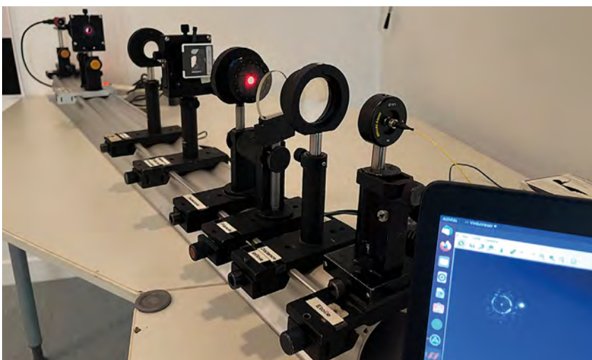
Figure 1 : Photographie du montage expérimental. Au premier plan, l'écran montre l'image coronagraphique du système étoile-planète de laboratoire observé en simultané par la caméra.
