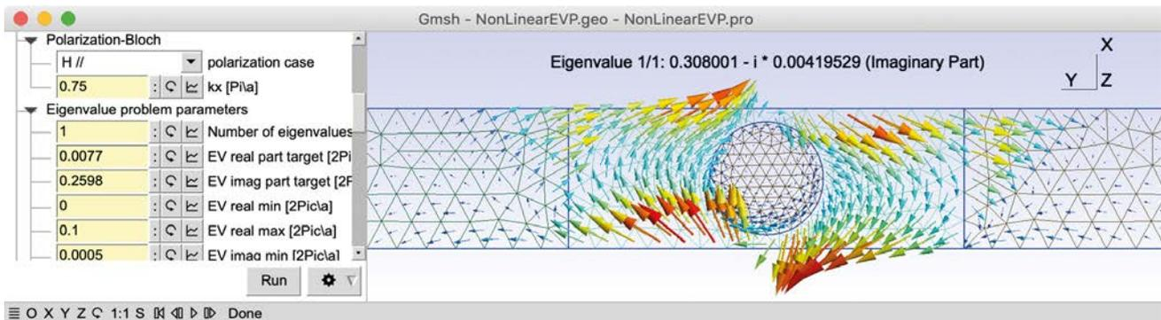
**Figure 4.** Mode fondamental d'un réseau de tiges circulaires de permittivité dispersive régie par un modèle de Drude (modèle **NonLinearEVP.pro**). Le problème aux valeurs propres est alors non-linéaire.
