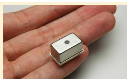
Figure 3a. Microspectromètre développé par Hamamatsu.
