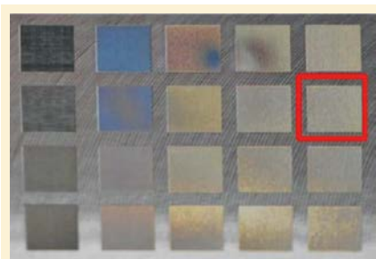
Figure 2. Zones découpées sur alliage de titane à des conditions opératoires variables. (Crédit: Airbus Safran Launchers SAS / 2015 B. Rameau)
