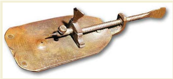
Microscope de van Leeuwenhoek, d'une taille d'environ 5 cm. La lentille est placée dans le trou et l'objet, piqué sur la pointe en métal, est déplacé à l'aide des 3 vis devant la lentille. L'ensemble est tenu très près de l'œil, face à la lumière, et permet d'observer des objets de quelques microns.
