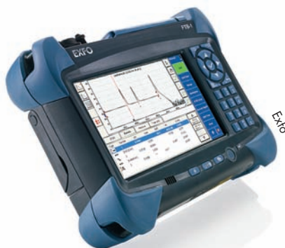
Photo 3. Plateforme de réflectomètre optique pouvant accueillir divers modules spécifiques complémentaires.
