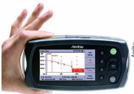
Photo 1. La miniaturisation s'invite avec ce modèle de micro-OTDR.
