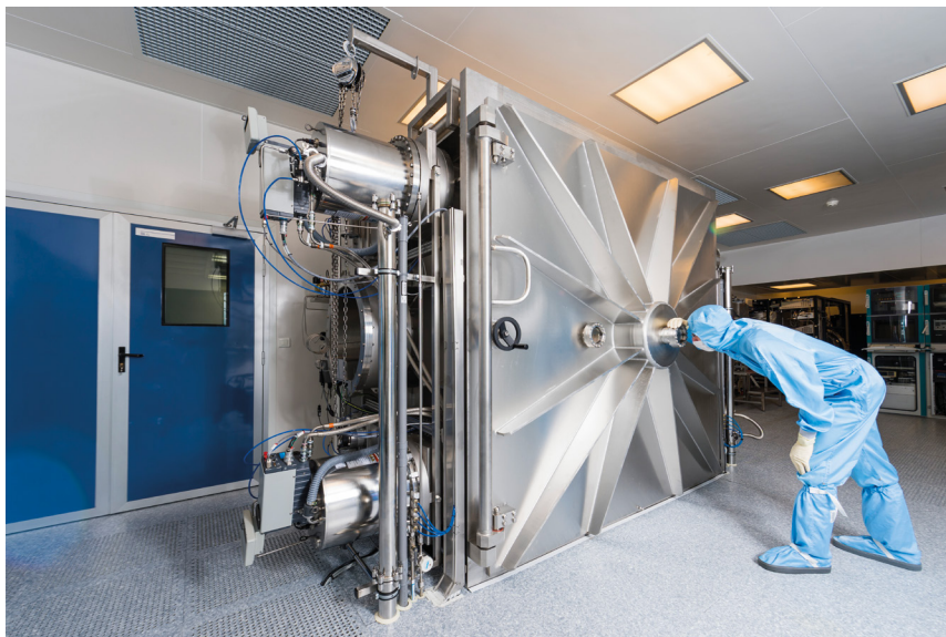
Figure 1. Bâti de dépôt IBS développé pour Virgo (©Cyril FRESILLON LMA CNRS Photothèque_2016)
