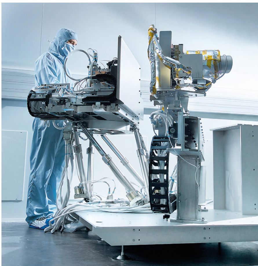
Figure 5. Hexapode en salle blanche ISO5 intégré dans un banc de test optique - Crédits : Bertin Technologies
