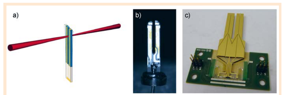
Figure 7. (a) Schéma de principe de la photoacoustique à diapason ; (b) photographie d'un diapason horloger; (c) photographie du diapason Ultimate conçu à l'Onera.
