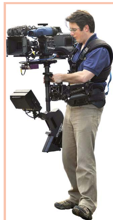
Figure 4. Solution de système gyrostabilisé pour optronique multimédia. (Crédit photo : SteadyCam)
