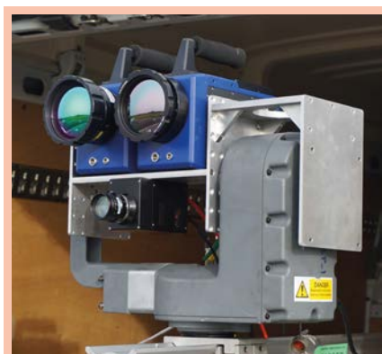
Figure 2. Tourelle optronique de poursuite Onera composée d'une tourelle Instro et de 3 imageurs IR.
