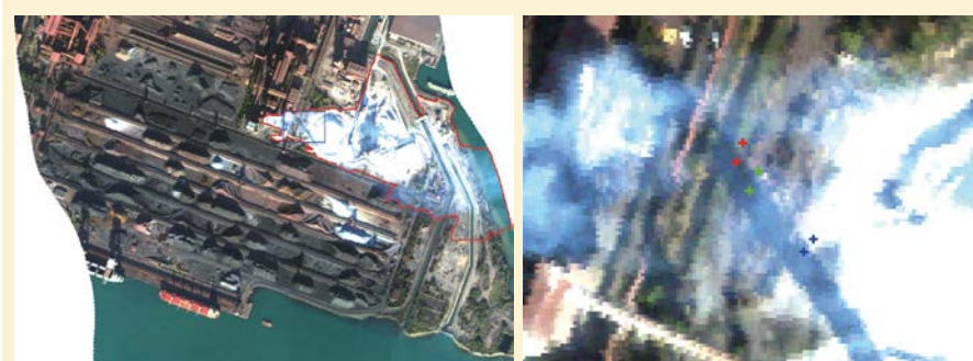
Figure 3. (a) Image hyperspectrale CASI ( \lambda_B = 458 \text{ nm} , \lambda_V = 549 \text{ nm} , \lambda_R = 640 \text{ nm} ) acquise le 28 octobre 2010 sur le site d'une industrie métallurgique à Fos-sur-Mer (la ligne rouge indique le contour du panache). (b) Zoom correspondant au rectangle bleu et localisation des couples de pixels sélectionnés (marqués en rouge, vert et bleu).
