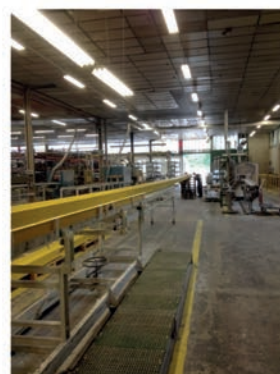
Pultrusion d'une poutre en composite équipée de 6 fibres optiques
