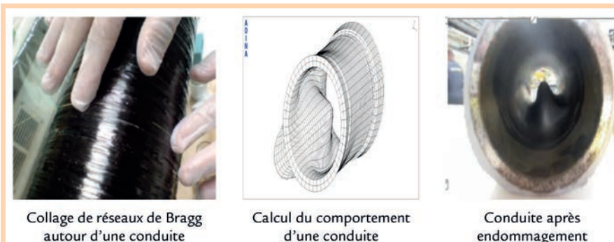
Figure 8. Conduites en acier équipées de chapelets de 4 réseaux de Bragg sur leur périmètre extérieur et suivi de leur comportement sous pression.
