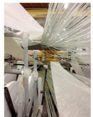
Bobine de fibres équipées de réseaux de Bragg avant insertion en composite
