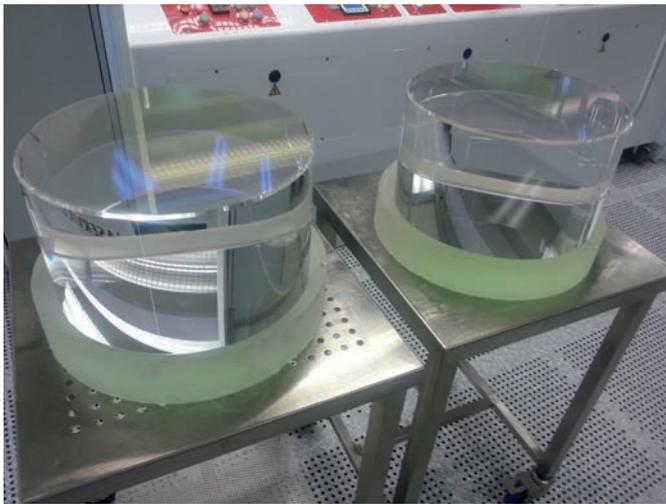
Figure 5. Miroir de fermeture de la cavité de l'interféromètre Advanced Virgo après traitement (diamètre 35 cm, épaisseur 20 cm).
