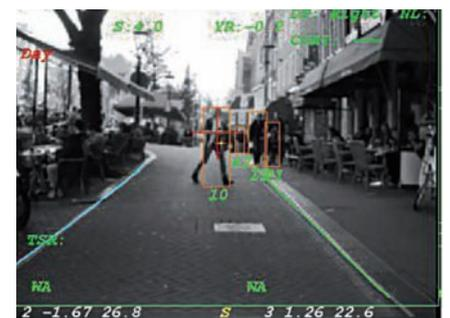
Figure 7. Détection de piétons (Mobileye).
