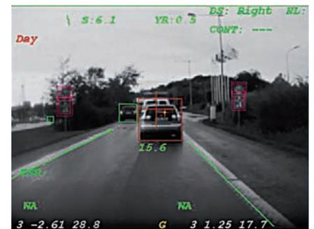
Figure 6. Détection de véhicules, de marquages au sol et de panneaux (Mobileye).
