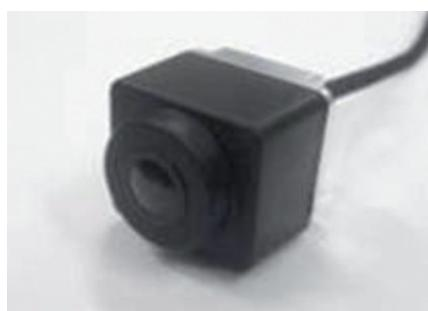
Figure 4. Caméra de recul équipant la Citroën DS5.
