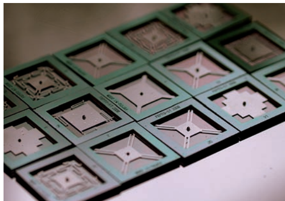
Figure 7. Collection d'actionneurs électrostatiques à déplacement précis dans le plan (X-Y) et à plaques parallèles portant une microlentille.
