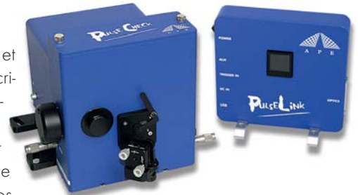
Figure 3. Deux exemples d'auto-corrélateurs.
