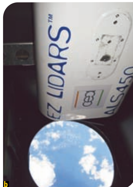
Figure 2. Vue du lidar installé dans le Falcon 20 de l'unité SAFIRE.
