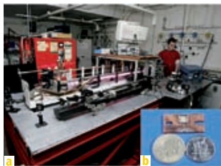
Figure 2. Illustration des tailles typiques d'un laser térahertz à gaz (a) et d'un laser térahertz à cascade quantique (b).
